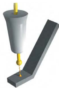
安定したEFOの放電で安定したフリーエアーボールを形成
